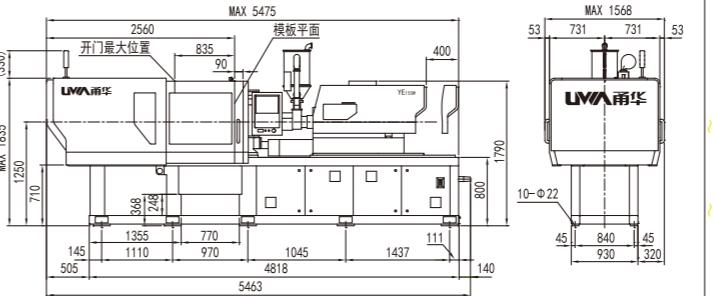
冷却水分配器、配电箱进线孔、工业插座 / 位置尺寸
