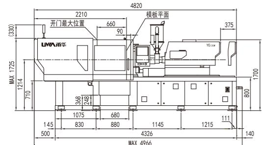
冷却水分配器、配电箱进线孔、工业插座 / 位置尺寸
